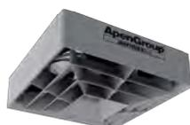
Ventilatoren zur Warmluftrückführung verringern den Transmissionswärmeverlust in Hallen mit großer Innenhöhe. Warme Betriebs- oder Heizungsluft die sich unter der Decke sammelt wird in den Raum rückgeführt. Deckenventilatoren bringen die Wärme effektiv und schonend in den Aufenthaltsbereich. Heizkosteneinsparungen von über 30% sind möglich.
